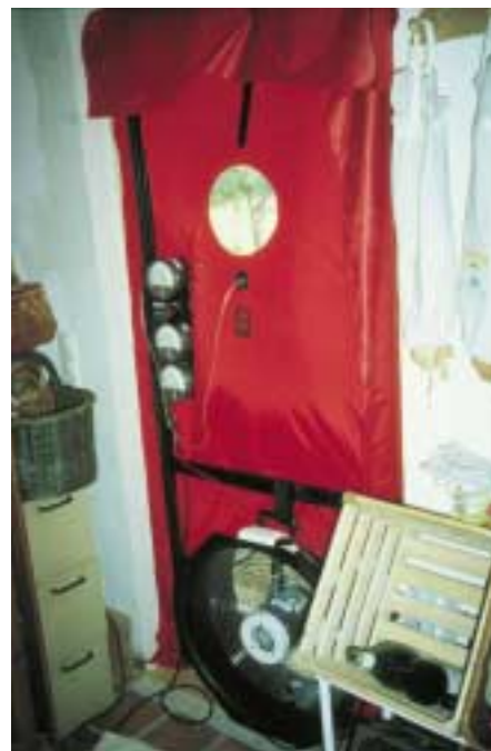
Abb. 3 Messung der Luftdichtheit mit der Blower Door
